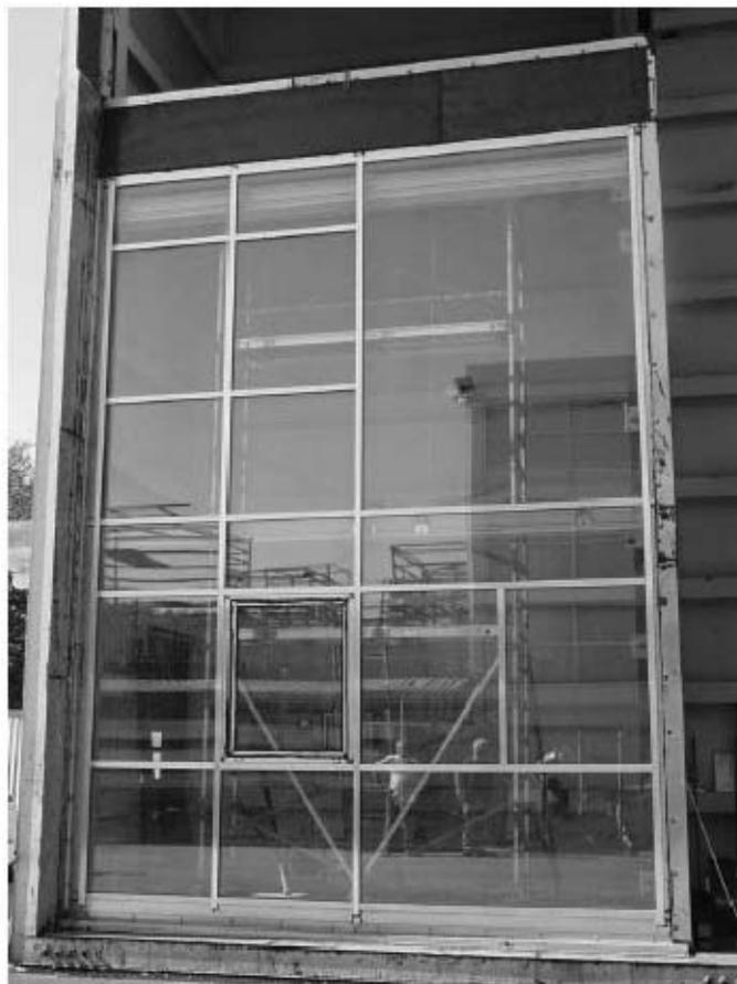
Bild 1 Fassade in Prüfstand eingebaut
