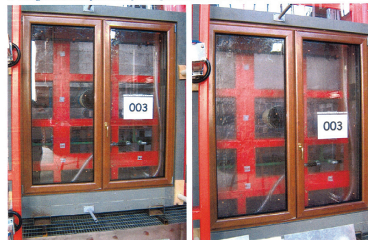
Foto 1 e 2: Campione sottoposto a prova nell'assetto sperimentale e durante i test di tenuta all'acqua
