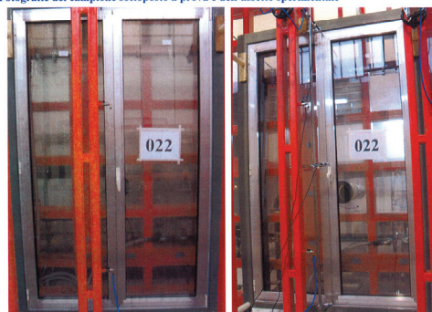
Foto 1 e 2: Campione sottoposto a prova nell'assetto sperimentale e durante i test di resistenza al carico del vento (prova di deformazione a pressioni positive e negative)
