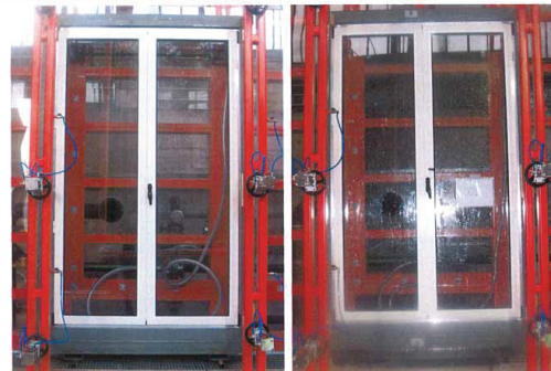
Foto 1 e 2: Campione sottoposto a prova nell'assetto sperimentale e durante i test di tenuta all'acqua
