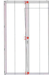
Fig. 6: Assetto sperimentale prova di resistenza al carico del vento: schema di posizionamento dei trasduttori (vista interna)
